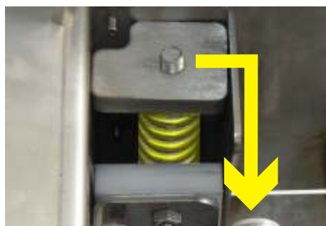
4. Force d'appui réglable (DUO Drive RS)
